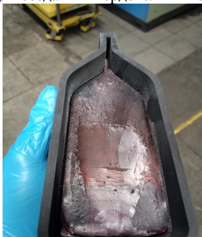
Рис.2. Синтезированный методом ГНК крупногабаритный монокристалл \text{La}_{1-x-y}\text{Ba}_x\text{Pb}_y\text{F}_{2,94} ( x = 0,44 ; y = 0,06 ) в графитовом тигле с содержанием \text{PbF}_2 около 6% (моль).
